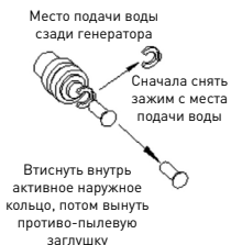
ШАГ 1: Снять противо-пылевую заглушку
